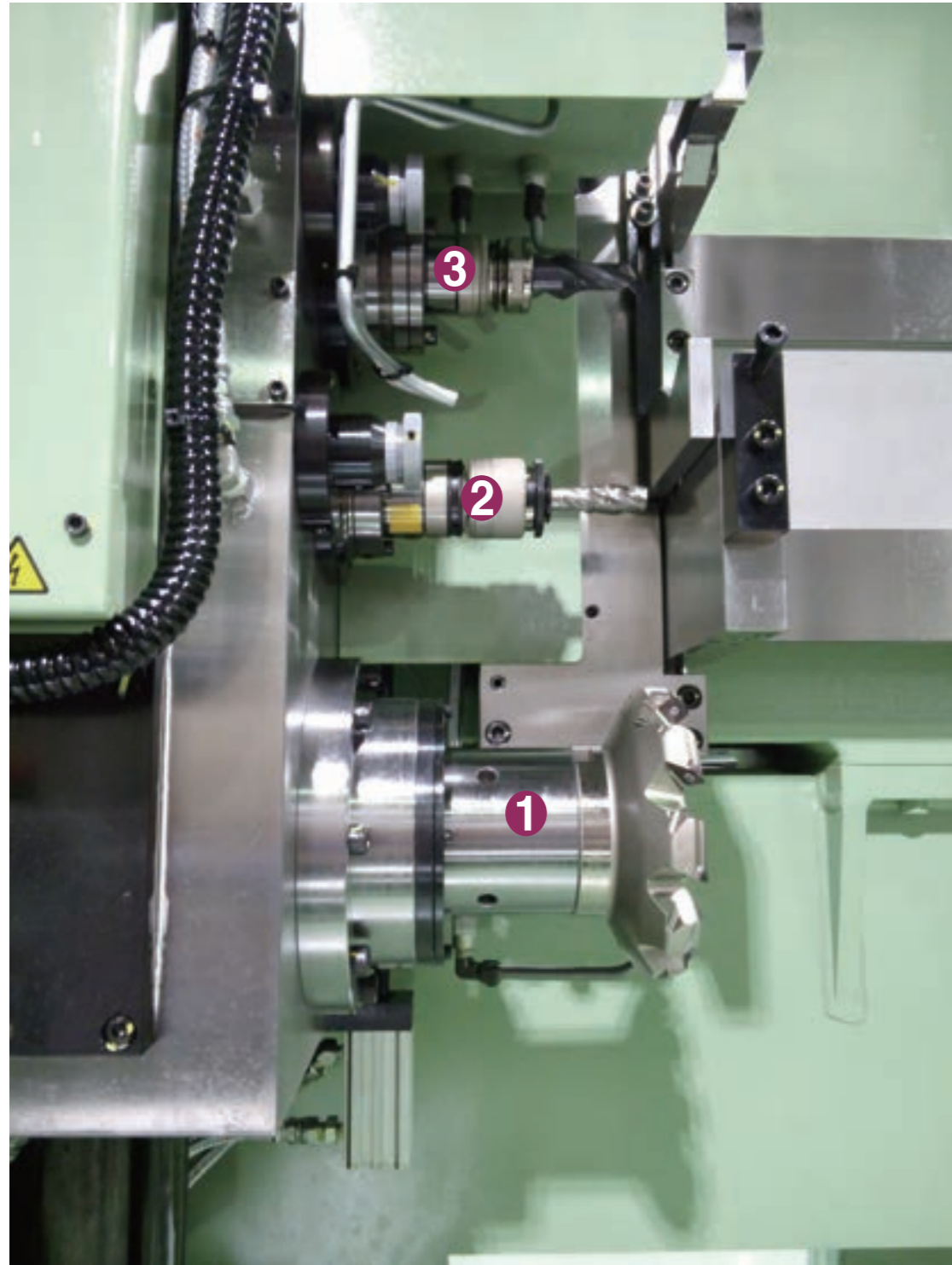
①フライスカッター軸 ②タップ加工軸 ③下穴加工軸
